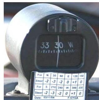
Compas et sa courbe de déviation (d) ↗
