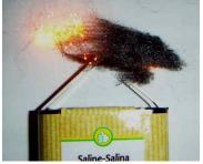
Lors de la mise en court ó circuit de la pile, la paille de fer brûle, des étincelles sont observées. Le courant est suffisamment important pour échauffer le matériau. On risque ainsi de déclencher un incendie. Dans tous les cas, la pile (ou le générateur) est endommagé.
