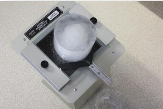
On laisse le glaçon fondre à la seule chaleur de la salle. On mesure la masse fondue pendant une durée chronométrée.
