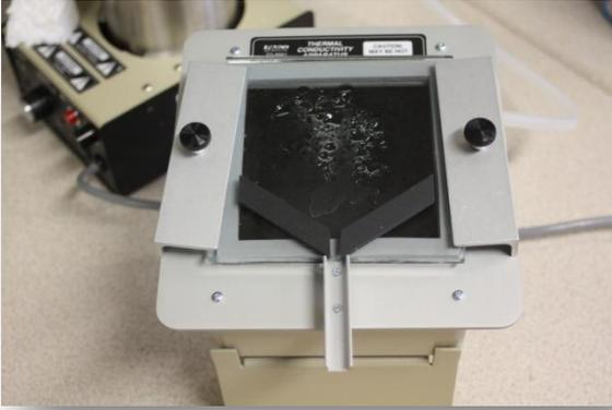
On met en place dans l'appareil une plaque de verre.
