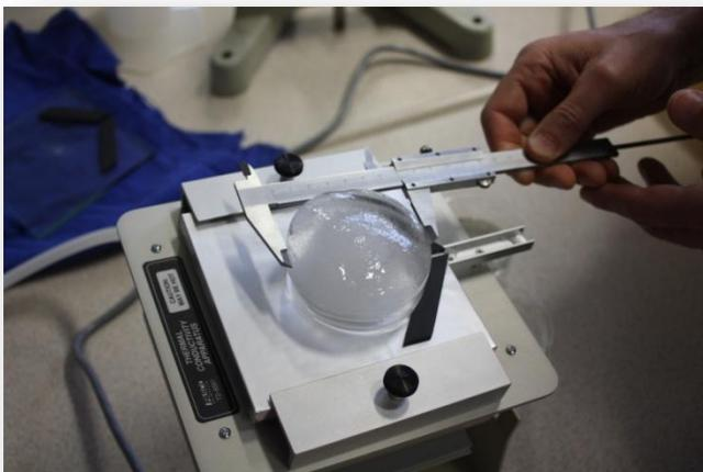
A la fin de l'expérience, on mesure le diamètre du bloc de glace. Il est important de bien définir la surface d'échange, ce qui peut être discuté avec les élèves. Seule sera prise en compte la surface couverte par le bloc de glace.
