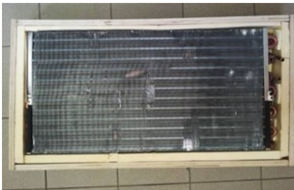
Panneau thermique réalisé à partir d'un échangeur de climatisation (environ 40 cm x 80 cm)
