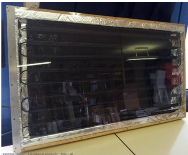
Panneau thermique complet à base d'un échangeur de réfrigérateur.
