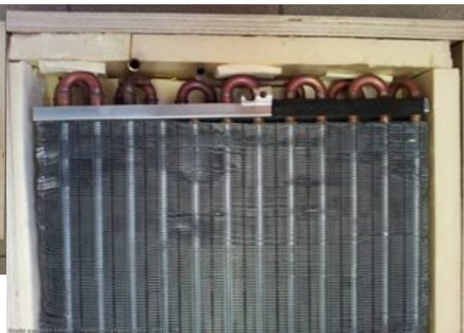
Détail de l'échangeur, partie raccordement
