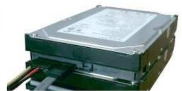
Le standard Serial ATA est basé sur une communication en série. Une voie de données est utilisée pour transmettre les données et une autre voie sert à la transmission d'accusés de réception. Elle remplace les liaisons IDE
