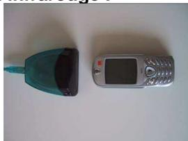
La communication infrarouge utilise la lumière infrarouge pour transférer des données dans les télécommandes pour téléviseurs et magnétoscopes. Dans les ordinateurs, la communication infrarouge offre une alternative au câble. Elle donne un moyen économique de relier des ordinateurs entre eux ou avec des périphériques et autres dispositifs. Il ne doit pas y avoir d'obstacle entre l'émetteur et le récepteur. Le débit est de 10Mb/s pour une distance de 30m
