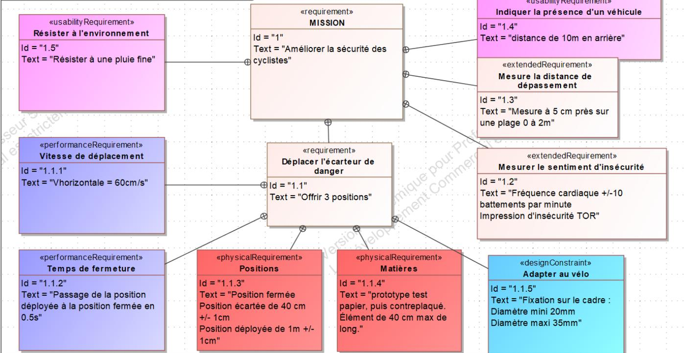
bdd [Paquet] 3/1- Diagramme de définition de blocs [ Définition de blocs ]
