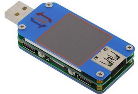
Cette interface comporte plusieurs ports USB afin d'obtenir la compatibilité la plus large possible: USB 2.0, Micro-USB et USB Type-C.
